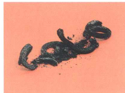
Асбестовая набивка с графитом. Необходимо выскребание сальниковой камеры.
